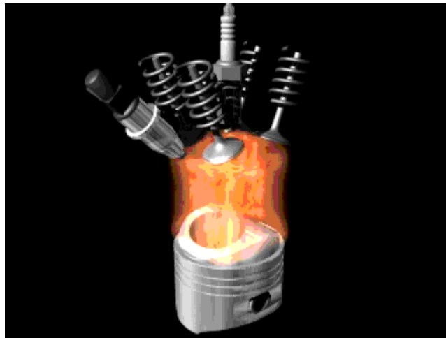
(圖四)GDI 引擎的運作原理
